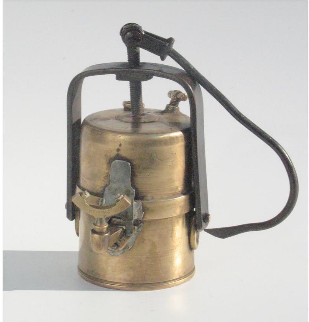
Lampe à acétylène portable à feu nu. Bec conjugué de type « Bray ». Ce type de lampe fut très utilisé jusque dans les années cinquante dans les mines métallifères et dans bon nombre de charbonnages non grisouteux. Un réflecteur vertical ou incliné (manquant sur ce modèle) concentrait la lumière.
