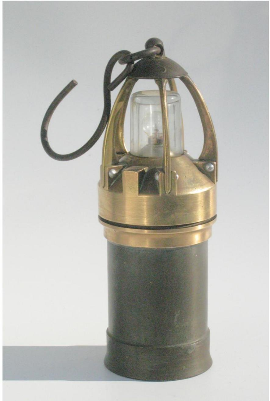
Lampe à tête ogivale de bronze fabriquée à DOUAI par l'auxiliaire des mines en 1932. Fermeture magnétique. Accumulateur au plomb.
