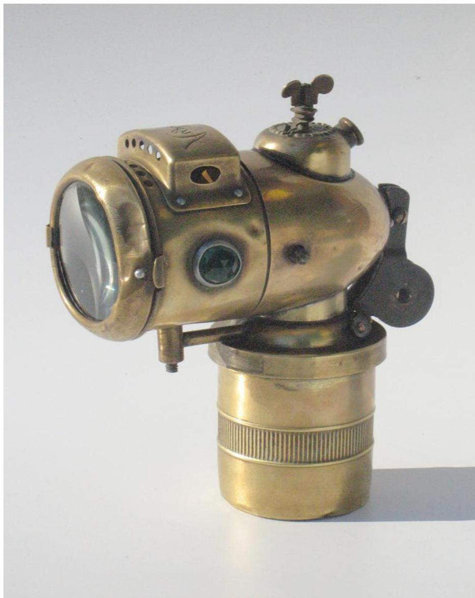
Lampe à acétylène de marque AIGLON qui, jusqu'à la fin de la seconde guerre mondiale, équipait les vélos et les petites motos. La faible capacité des deux réservoirs ne confère à la lampe une faible leur autonomie. A l'avant, un verre convexe et transparent concentre la luminosité pour en augmenter la portée.
