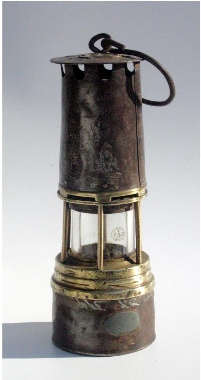
Lampe standard à benzine de la commission de 1918 fabriquées par la firme d'Arras permettant de détecter le grisou. Ce modèle allait progressivement remplacer tous les autres dans les mines françaises et sarroises.
