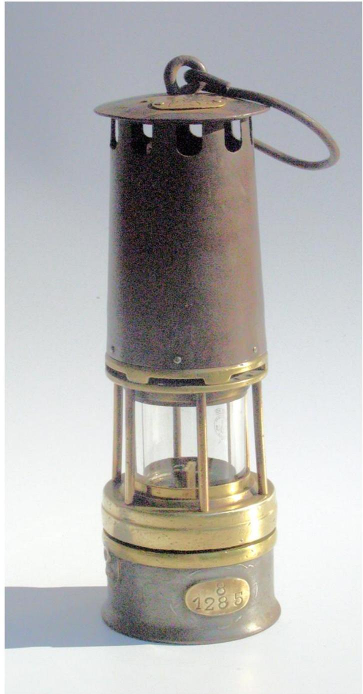
Lampe de sûreté à flamme «ARRAS» type C à allumage condamné. Ce modèle était utilisé dans les mines très grisouteuses. Verrouillage latéral magnétique.
