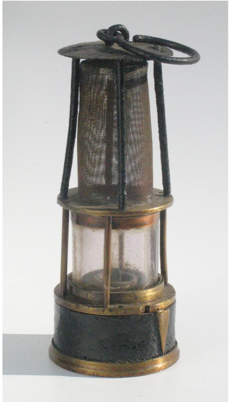
Lampe de huile en usage dans les charbonnages jusqu'au début du vingtième siècle. Elle est équipée d'une fermeture à vis avec verrouillage vertical.
