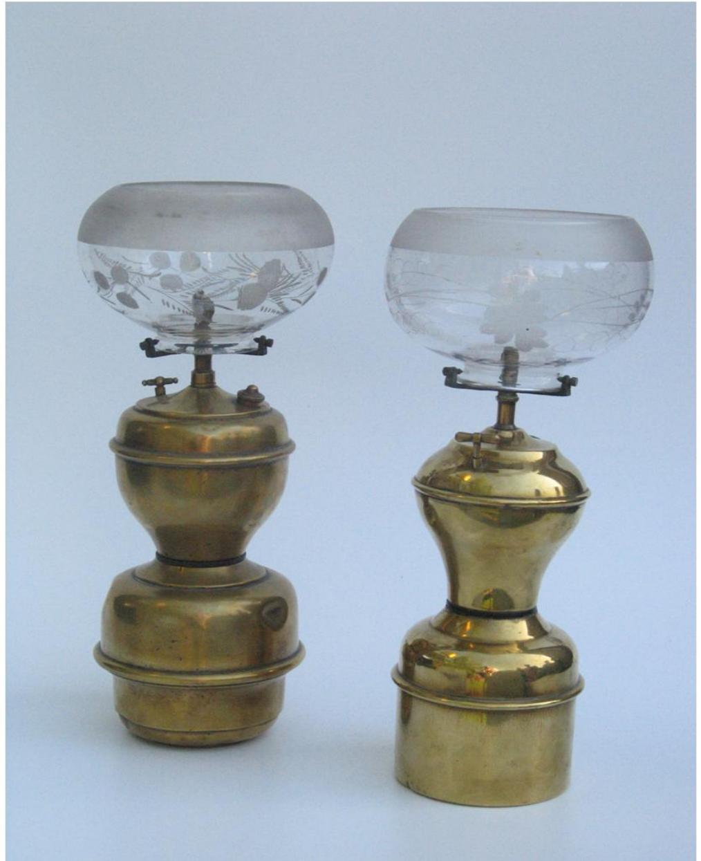
Lampes "universelles" en laiton poli. Chute d'eau réglable par pointeau. Bec d'éclairage en stéatite. Griffes cuivre fondu trois branches avec globe de cristal dépoli et gravé. Ces lampes pouvaient être utilisées seules ou intégrées dans une suspension.
