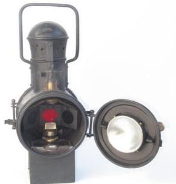
Mis à l'arrière du dernier véhicule, ce fanal permet, outre le repérage de la queue du train, d'avoir l'assurance que le train est « complet ». Fonctionnement à pétrole. Origine : Gare de Poitiers.
