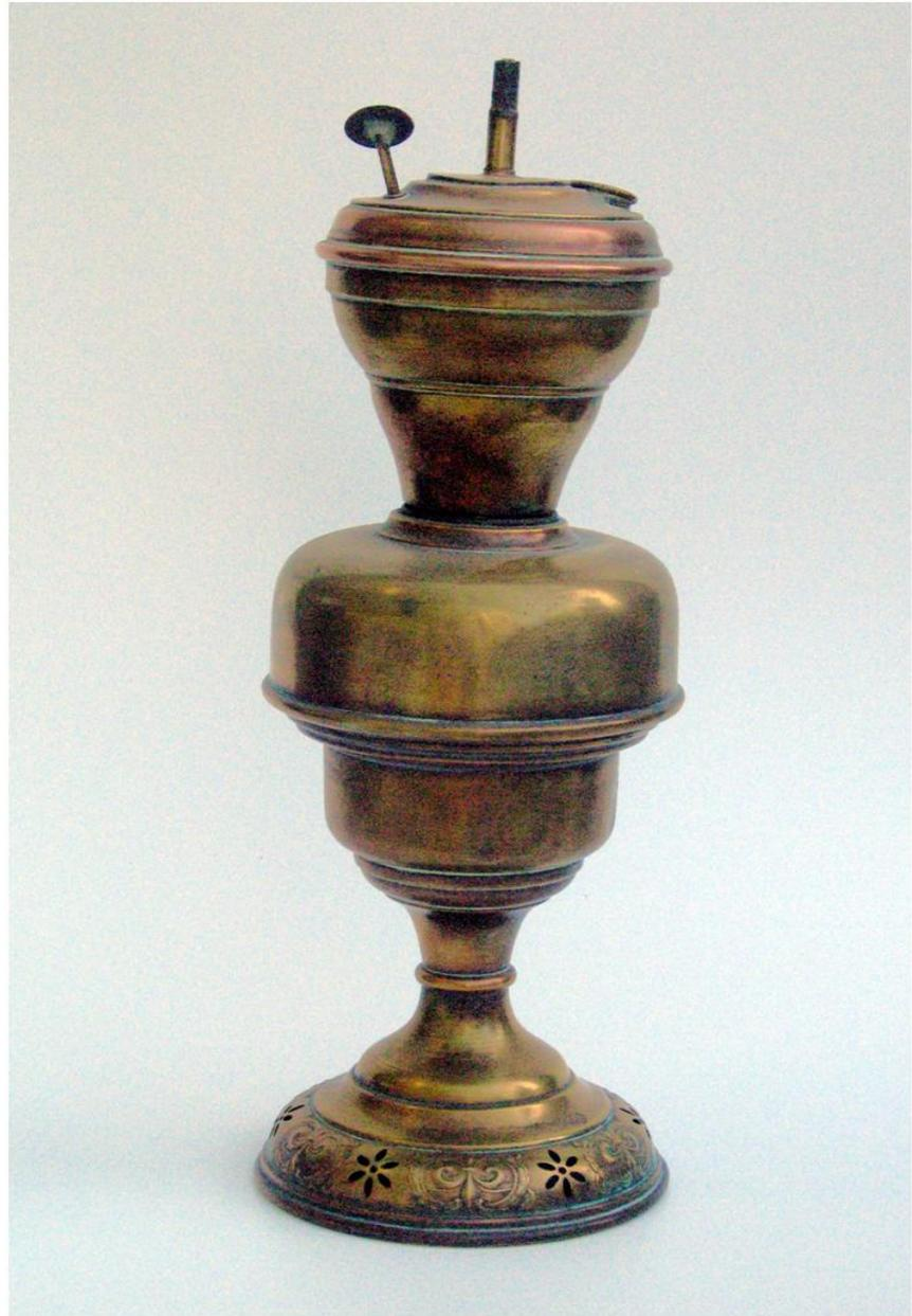
Lampe de table a pied en laiton. Pied lesté assurant une stabilité parfaite. Ce même réservoir pouvait se transformer en lampe à pétrole (adjonction d'un bec Kosmos 14 lignes), en lampe à gaz (adjonction d'un transformateur à gaz) ou en lampe à acétylène (photo ci-dessus) par l'adjonction d'un réservoir à eau.
