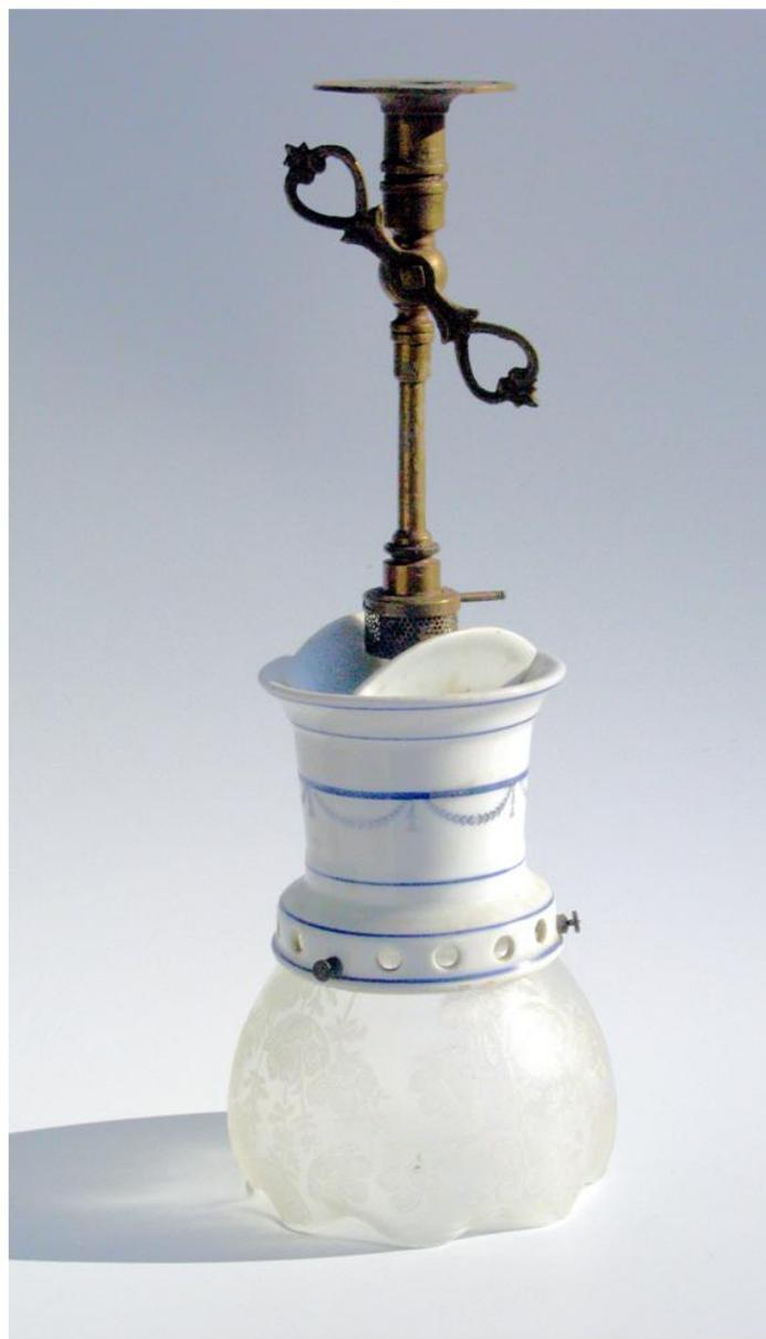
Tige plafonnier en laiton pour bec à gaz renversé en cuivre poli. Robinet à levier dit « veilleuse » permettant de baisser la flamme sans l'éteindre. Bec à incandescence à flamme renversée en porcelaine blanche avec décor bleu roi équipée d'un globe en cristal gravé.
