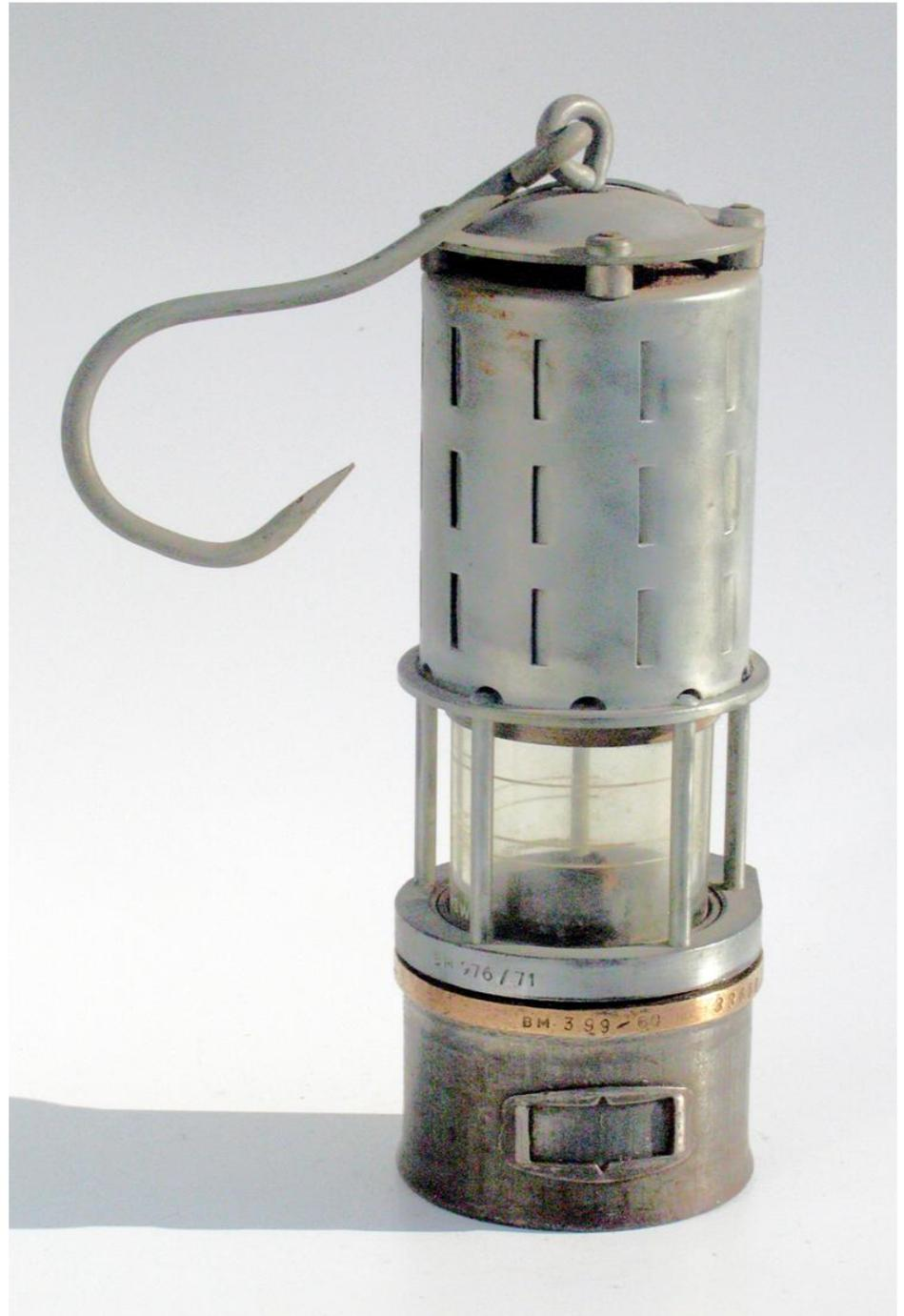
Lampe de fabrication polonaise à benzine équipée d'une cuirasse a fente verticale. Vers 1975
