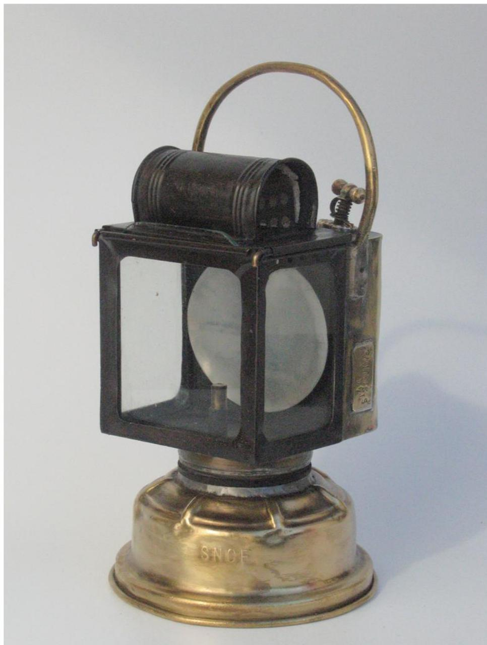
Lanterne de chemin de fer à trois faces. Réservoir à carbure en laiton estampillé SNCF. Corps en tôle de fer. Cette lampe pouvait être munie de verres colorés. Gare de rattachement : Saint-Saulve.
