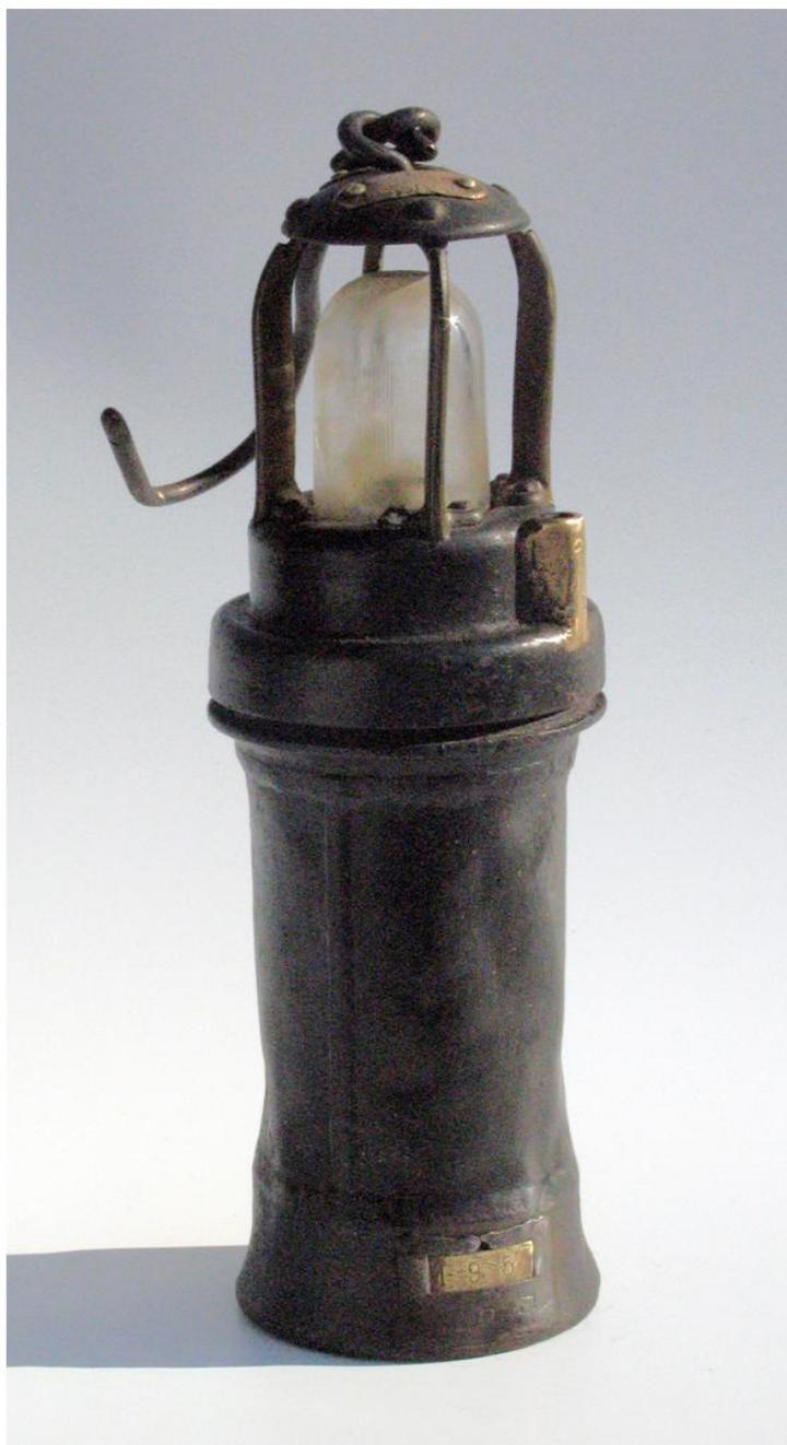
Lampe électrique portable « ARRAS » (modèle 334) à fermeture magnétique en tôle d'acier et bronze de 1932. Fermeture magnétique. Accumulateur au plomb.
