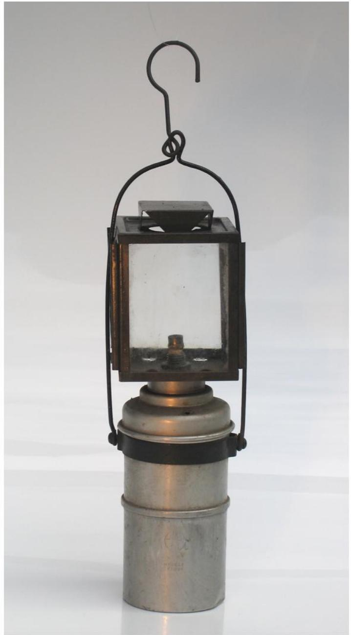
Petite lampe portative. Socle en aluminium. La flamme est entourée d'une petite cage de protection en fer blanc. Petite anse permettant l'accrochage.
